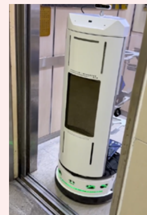
▲智慧物流機器人於進行跨層樓，出電梯的照片
