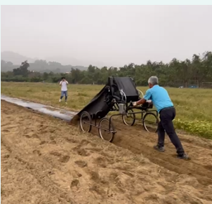
▲ 雙回收動力電池之農業跟隨車與農膜回收機
