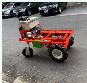
▲ 雙回收動力電池之農業跟隨車與農膜回收機
