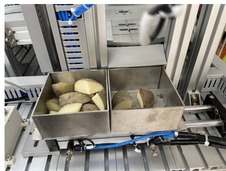
▲ 一貫化馬鈴薯生產設備與導入影像辨識與自動設備之智慧化種薯切塊機構
