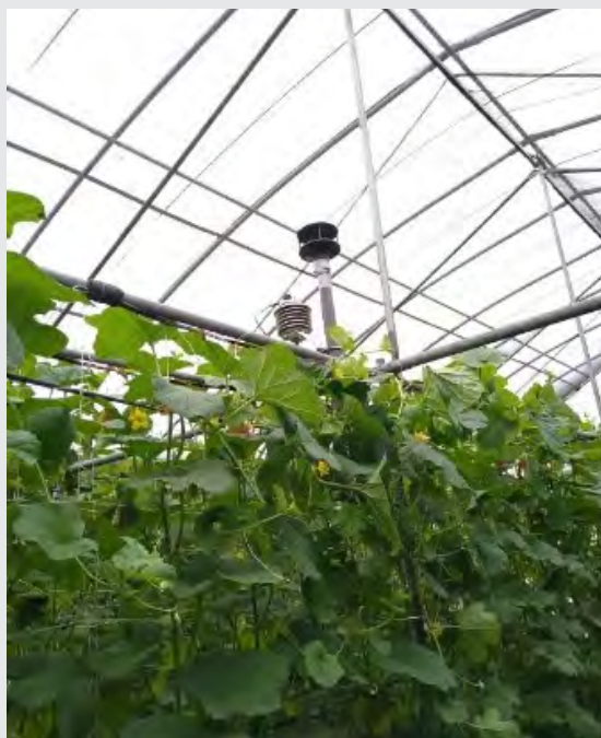
▲溫室內架設感測及器，包含溫濕度感測器、光度計、二維音波風速計
